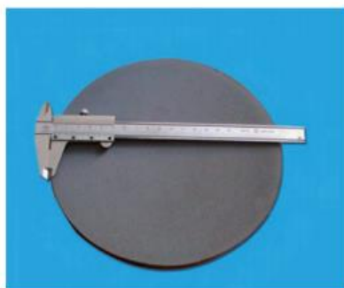
(b) 热丝CVD，直径200 mm，厚度约1 mm
