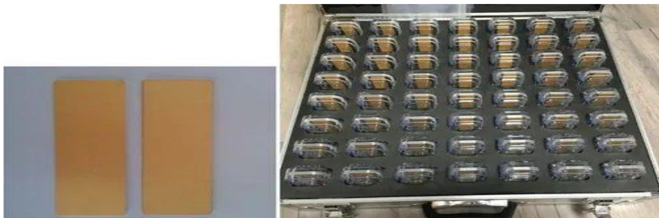
左：由大功率直流电弧等离子射流制备的金刚石散热器；右：北斗七星导航卫星中诞生的太空相控阵天线。 资料来源：人工晶体报
